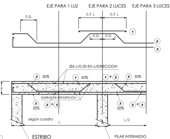
ALCANTARILLA OBLICUA DISPOSICIÓN DE ARMADURA PARA VALORES DE α ENTRE 45° Y 85°
