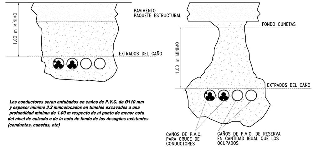
Los conductores serán entubados en caños de P.V.C. de Ø110 mm y espesor mínimo 3.2 mm colocados en túneles excavados a una profundidad mínima de 1.00 m respecto de al punto de menor cota del nivel de calzada o de la cota de fondo de los desagües existentes (conductos, cunetas, etc)
