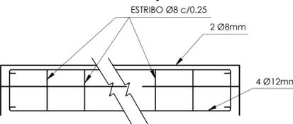
CUADRO 2 -DIM. DE LOSA Y ARMADURA-
