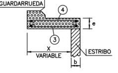
DISPOSICION DE ARMADURA DE ALCANTARILLA OBLICUA PARA VALORES DE α ENTRE 45° Y 85°
