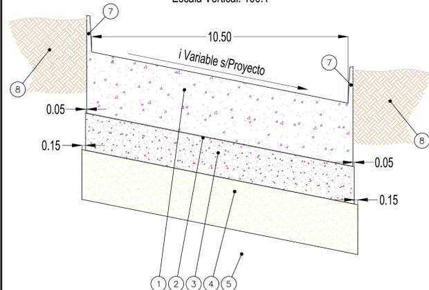
**PERFIL ESTRUCTURAL N°4 - PAVIMENTO DE HORMIGÓN**
