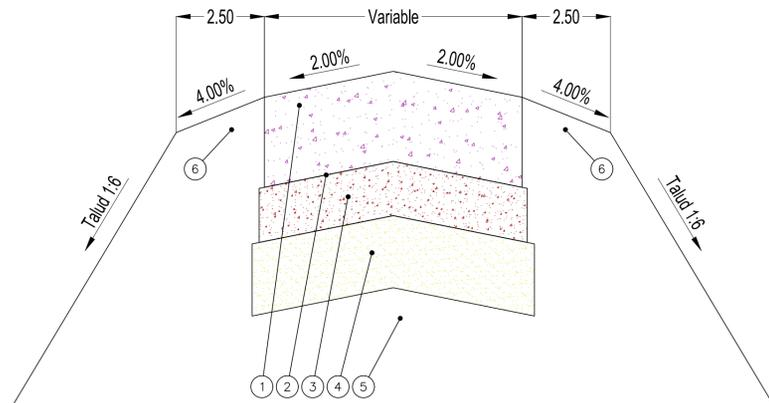
**PERFIL ESTRUCTURAL N°2 - PAVIMENTO DE HORMIGÓN**
