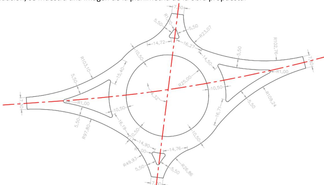
Imagen 9.1.1 – Planimetría Rotonda Intersección RN N°12 y RP N°9
